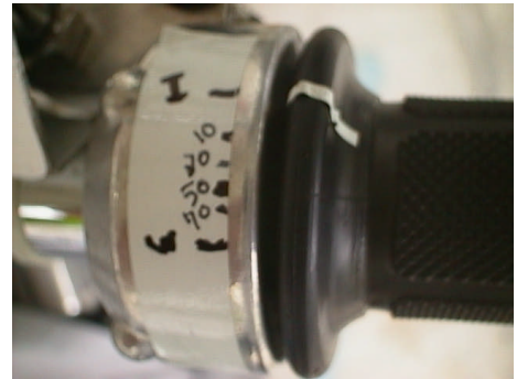
データモニターの画面で確認したスロットル面積開度率を貼り付けたテープ上に記録します。
