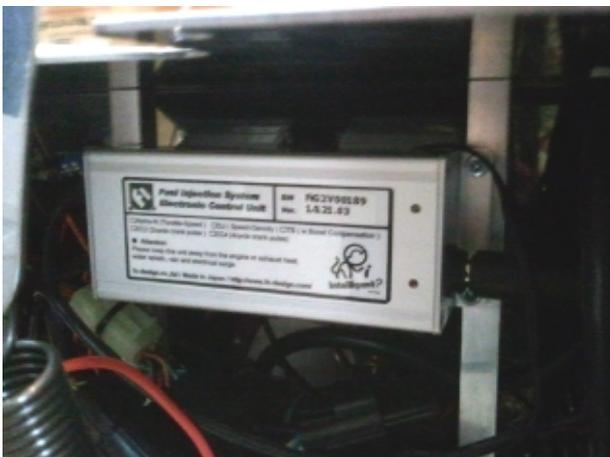
弊社のFIを搭載し、PCを接続することで簡単に燃料噴射、点火タイミングのセッティングができます。
