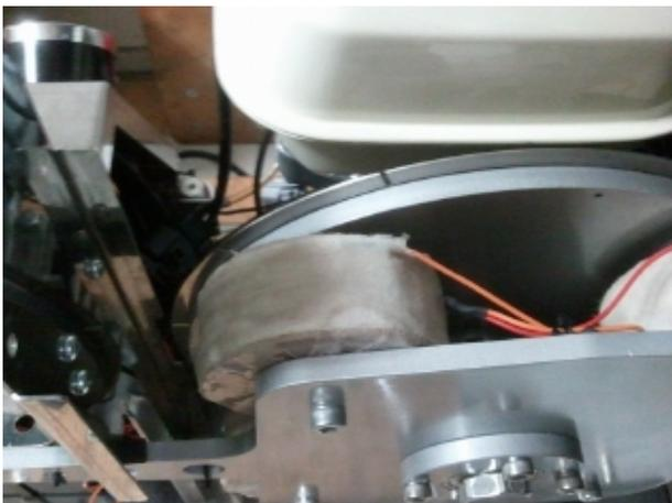
渦電流式制動装置でエンジンに一定の負荷が掛けられます。
