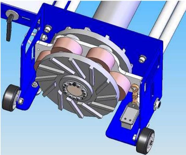
渦電流式リターダでローラーにブレーキを掛けて駆動力を計測する
