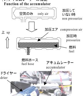
機能 : 空気を圧縮して蓄圧し、燃圧変動を抑えます。
