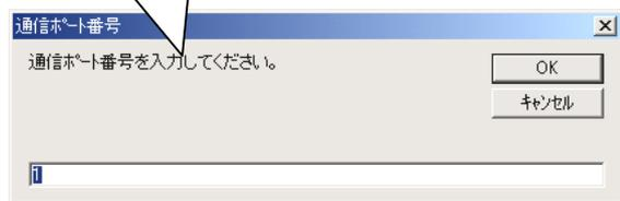
※ 変更された通信ポート番号を調べる場合(接続したポートの番号がわからないときなど)は、スタートメニューの「設定」→「コントロールパネル」から「システム」をダブルクリックし、ハードウェアのタブの「デバイスマネージャ」のボタンをクリックしてください。右図のような画面が表示されますので、ポート(COMとLPT)のツリーを展開してください。USBシリアルコンバータを使用しているときは、その名前と番号が表示されているはずですが。
